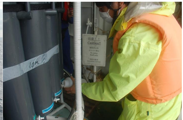
採水後のニスキン採水器からの水質サンプル海水収納
